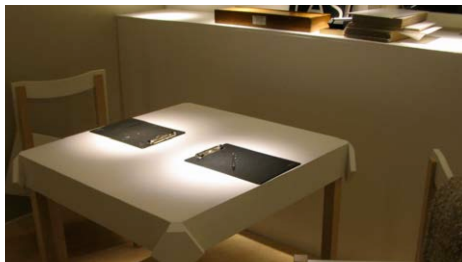
Testrummets bord belyst med en LED-spot med färgtemperatur 4000K respektive två LED-spotar med färgtemperatur 2700 K
